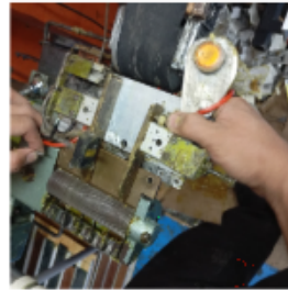
3. IKABIT ANG GUIDE SA ROLLER MACHINE DAHIL DITO PAPASOK ANG STRAP NG BELT
